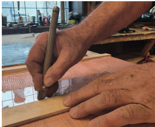
Riktig lyd er viktig når du skal skjære glass. Foto: Ellev Steinsli
