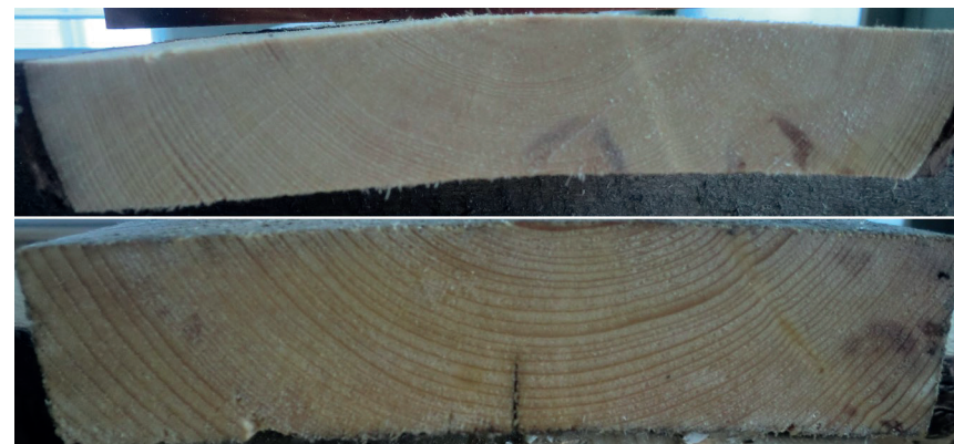
To planker tatt fra omtrent samme sted i hver sin tømmerstokk. Den øverste har veldig tette årringer, ca 20 årringer per cm. Den vil tåle sol, vann og belastning mye bedre enn den nederste som har relativt store årringsbredder, ca. 4-5 årringer per cm. Foto: H.A. Lien, 2018
